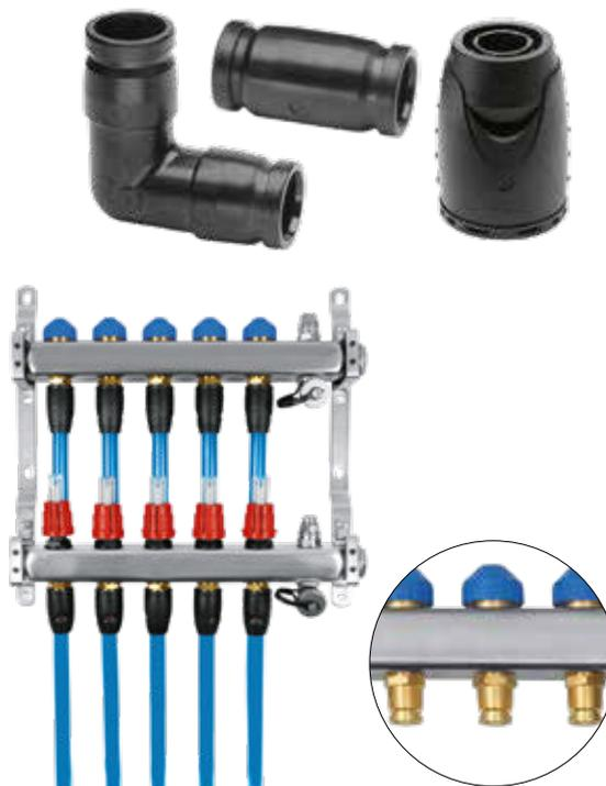
Hierauf müssen an der Baumaßnahme nur noch VR Adapter aufgeclipst werden, in die dann letztlich die Verbundrohre gesteckt werden. Auch hier ist das Entgraten und Kalibrieren der Rohre obligatorisch.
