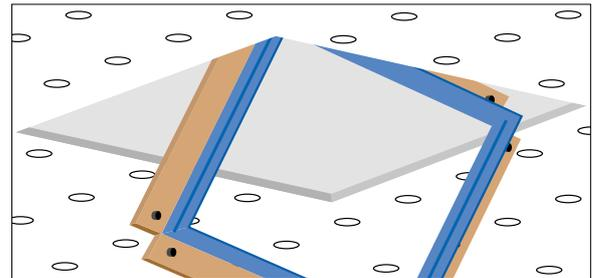
5. Revisionsklappe aus dem Rahmen lösen, Rahmen einsetzen und mit Passbolzen ausrichten
