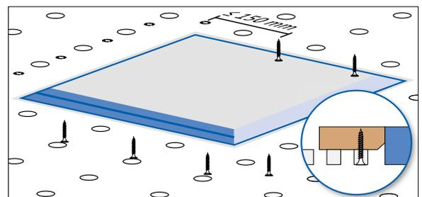
6. Rahmen festschrauben; Schrauben nach Herstellervorgabe verwenden
