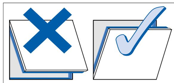
Die Revisionsklappe im senkrechten Zustand so einbauen, dass die Drucköffnung oben ist (nicht als
