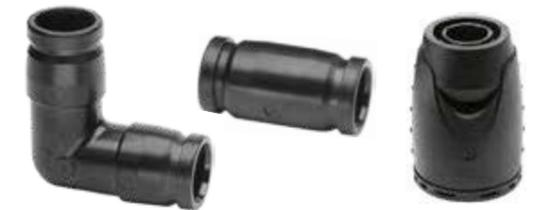
Die Verbindung besteht dabei aus einem VR Längs- oder VR Winkelverbinder und je zwei VR Adaptern. Die Adapter werden einfach auf den Verbinder aufgesteckt und Rohre lassen sich so leicht miteinander verbinden. Direkt nach dem Einstecken sind alle Verbindungen absolut dicht und nicht mehr demontierbar, ohne die Adapter hierbei zu zerstören.
