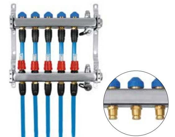
Die Regelkreisverteiler werden mit Übergängen an allen Vor- und Rückläufen ausgeliefert. Hierauf müssen an der Baumaßnahme nur noch VR Adapter aufgeclipst werden, in die dann letztlich die Verbundrohre gesteckt werden. Auch hier ist das Entgraten und Kalibrieren der Rohre obligatorisch.
